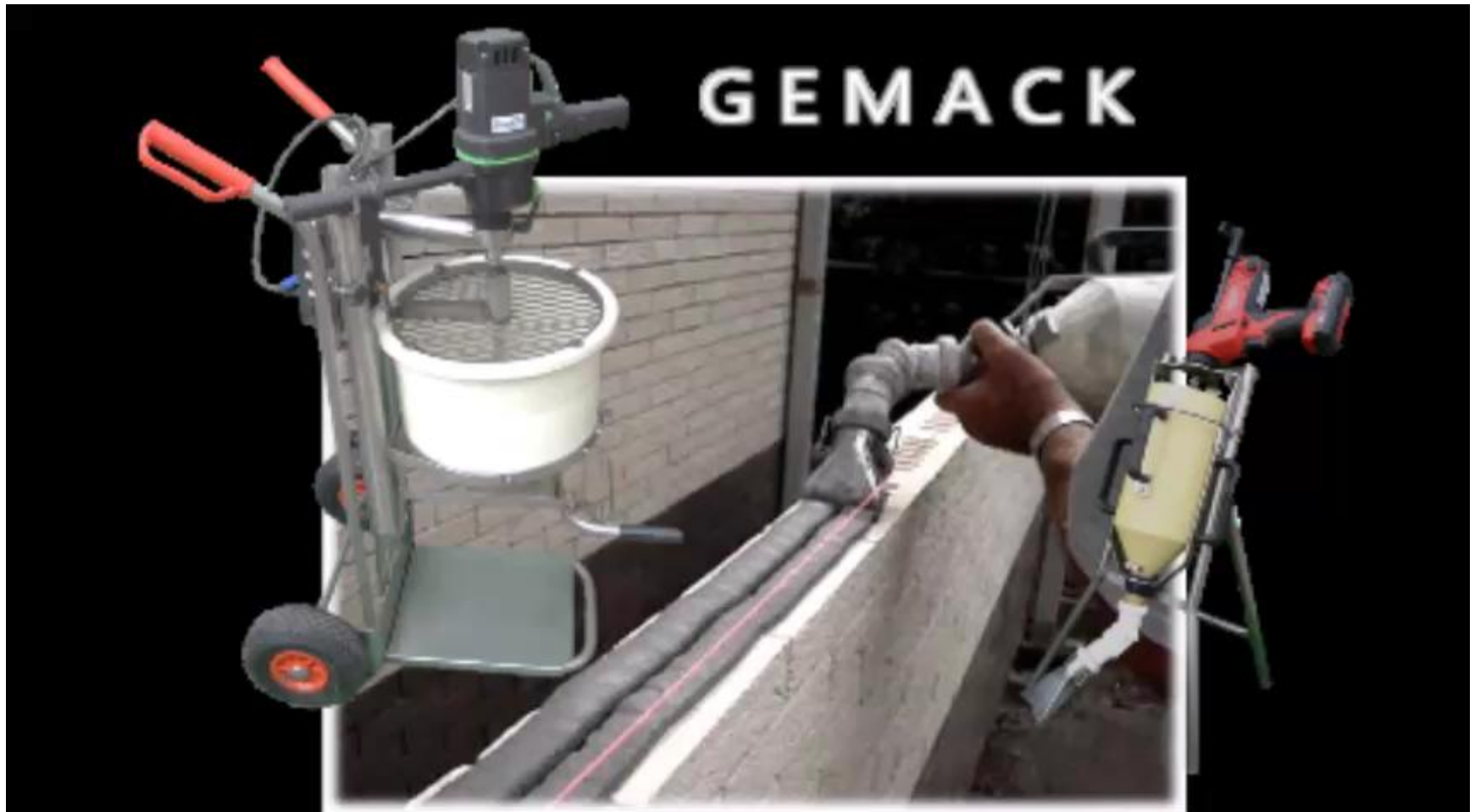
Het gedoseerd opbrengen van mortel met de Gema©k MortelSpuit
